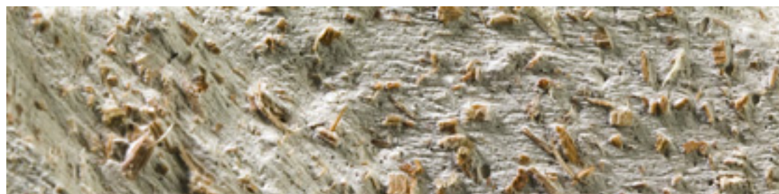
Dettaglio fibra di cellulosa nel cuore di gesso delle lastre PREGYDUR III.
